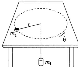
4. O sistema representado na figura é tal que a massa  $m_2$  se move sem atrito sobre a mesa horizontal e a massa  $m_1$  só pode movimentar-se verticalmente. O fio que une as massas é inextensível. Usando o método dos multiplicadores de Lagrange:
